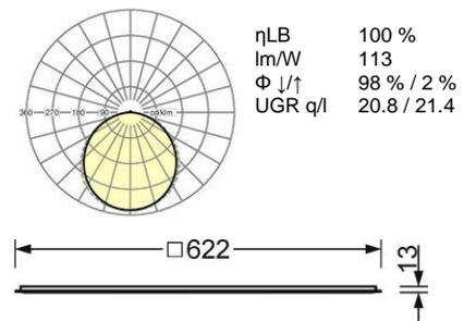
Einlege-/Einbauleuchte; Extrem flacher Aluminium Rahmen weiss gepulvert, Bauhöhe 13mm, verzinkte Stahlblechabdeckung, geeignet für Decken mit sichtbaren T-Schienen; Gehäusefarbe verkehrsweiß RAL 9016; Lichtverteilung direkt strahlend mittels opalem Diffusor aus Acrylglas; Externer LED-Treiber über 0,4m lange flexible Verbindungsleitung mit Leuchte betriebsfähig verdrahtet. Empfohlenes Zubehör für den Einbau in ausgeschnittene Decken, Einbau-Set PE-ES, separat bestellen.
