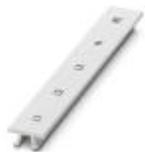
Zackband, Streifen, weiß, beschriftet, längs bedruckt: L1, L2, L3, N, PE, Montageart: verrasten in hoher Schildchennut, für Klemmenbreite: 16,3 mm, Schriftfeldgröße: 10,5 x 16,25 mm
