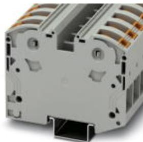
Hochstromklemme, Nennspannung: 1000 V, Nennstrom: 125 A, Anschlussart: Power-Turn-Anschluss, Anzahl der Anschlüsse: 2, Querschnitt: 2,5 mm<sup>2</sup> - 35 mm<sup>2</sup>, AWG: 12 - 2, Breite: 16 mm, Farbe: grau, Montageart: NS 35/15
