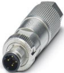
Steckverbinder, PROFINET CAT5 (100 MBit/s), 4-polig, halogenfrei, geschirmt, Stecker gerade M12 SPEEDCON, D-kodiert, Schneidklemmanschluss, Rändelmaterial: Zinkdruckguss, vernickelt, Kabelaußendurchmesser 5 mm ... 9,7 mm
