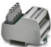
VARIOFACE-Modul, mit zwei Potenzialschienen (P1, P2) zur Potenzialverteilung, zur Montage auf NS 35-Tragschienen. Modulbreite: 70,4 mm
