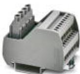
VARIOFACE-Modul, mit zwei Potenziialschienen (P1, P2) zur Potenzialverteilung, zur Montage auf NS 35-Tragschienen. Modulbreite: 70,4 mm
