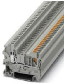
Durchgangsklemme, Anschlussart: Push-in-Anschluss, Schraubanschluss, Querschnitt: 0,14 mm<sup>2</sup> - 4 mm<sup>2</sup>, AWG: 26 - 14, Breite: 5,2 mm, Farbe: grau, Montage: NS 35/7,5, NS 35/15
