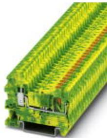
Schutzleiter-Reihenklemme, Anschlussart: Push-in-Anschluss, Schraubanschluss, Querschnitt: 0,14 mm<sup>2</sup> - 4 mm<sup>2</sup>, AWG: 26 - 14, Breite: 5,2 mm, Farbe: grün-gelb, Montage: NS 35/7,5, NS 35/15
