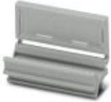
Gruppenbezeichnungsschild, einrastbar in Klemmenmitte für Schraub-, Zugfeder- und Schnellanschlussklemmen, beschriftbar mit Einsteckstreifen ESL 26 x 6 mm oder EST 25 x 6 mm, im Fußteil mit Zackband, Länge: 29 mm
