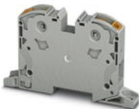
Hochstromklemme, Nennspannung: 1000 V, Nennstrom: 125 A, Anschlussart: Power-Turn-Anschluss, Anzahl der Anschlüsse: 2, Querschnitt: 2,5 mm<sup>2</sup> - 35 mm<sup>2</sup>, AWG: 12 - 2, Breite: 16 mm, Höhe: 68,3 mm, Farbe: grau, Montageart: direktes Anschrauben
