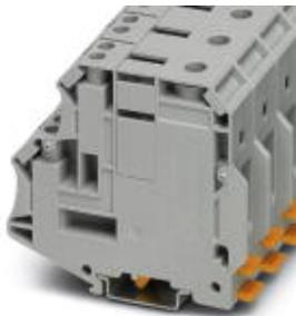
Potenzialsammelklemme, Nennspannung: 1500 V, Nennstrom: 192 A, Anschlussart: Schraubanschluss, Schraubanschluss, Anzahl der Anschlüsse: 5, Polzahl: 1, Querschnitt: 16 mm<sup>2</sup> - 95 mm<sup>2</sup>, AWG: 4 - 3/0, Breite: 20,3 mm, Höhe: 79,4 mm, Farbe: grau, Montageart: NS 35/7,5, NS 35/15, NS 35/15-2,3, NS 32
