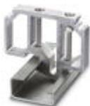
Endhalter, zur Endabstützung der UKH 50 bis UKH 240, wird auf die Tragschiene NS 32 geschoben und mit 2 Schrauben festgeklemmt, Breite: 10 mm, Farbe: aluminium
