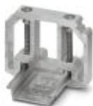
Endhalter, zur Endabstützung der UKH 50 bis UKH 240, wird auf die Tragschiene NS 35 geschoben und mit 2 Schrauben festgeklemmt, Breite: 10 mm, Farbe: aluminium
