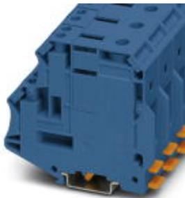
Potenzialsammelklemme, Nennspannung: 1500 V, Nennstrom: 192 A, Anschlussart: Schraubanschluss, Schraubanschluss, Anzahl der Anschlüsse: 5, Polzahl: 1, Querschnitt: 16 mm<sup>2</sup> - 95 mm<sup>2</sup>, AWG: 4 - 3/0, Breite: 20,3 mm, Höhe: 79,4 mm, Farbe: blau, Montageart: NS 35/7,5, NS 35/15, NS 35/15-2,3, NS 32
