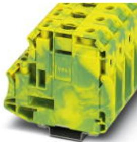
Schutzleiter-Reihenklemme, Anschlussart: Schraubanschluss, Schraubanschluss, Anzahl der Anschlüsse: 5, Polzahl: 1, Querschnitt: 16 mm<sup>2</sup> - 95 mm<sup>2</sup>, AWG: 4 - 3/0, Breite: 20,3 mm, Höhe: 79,4 mm, Farbe: grün-gelb, Montageart: NS 35/7,5, NS 35/15, NS 35/15-2,3, NS 32
