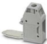
Abgriffklemme, Nennspannung: 1000 V, Nennstrom: 57 A, Anschlussart: Schraubanschluss, Anzahl der Anschlüsse: 1, Querschnitt: 0,5 mm<sup>2</sup> - 10 mm<sup>2</sup>, AWG: 20 - 8, Breite: 10,2 mm, Höhe: 34,7 mm, Farbe: grau, Montageart: auf Basiselement
