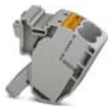
Abgriffklemme, Nennspannung: 1500 V, Nennstrom: 57 A, Anschlussart: Push-in-Anschluss, Anzahl der Anschlüsse: 2, Querschnitt: 0,5 mm<sup>2</sup> - 16 mm<sup>2</sup>, AWG: 20 - 6, Breite: 18,5 mm, Höhe: 34,7 mm, Farbe: grau, Montageart: auf Basiselement
