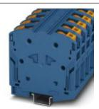
Hochstromklemme, Nennspannung: 1500 V, Nennstrom: 150 A, Anschlussart: Power-Turn-Anschluss, Anzahl der Anschlüsse: 2, Querschnitt:10 mm² - 70 mm², AWG: 8 - 2/0, Breite: 20 mm, Farbe: blau, Montageart: NS 35/15
