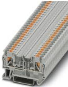
Durchgangsklemme, Nennspannung: 400 V, Nennstrom: 24 A, Anschlussart: Push-in-Anschluss, Anzahl der Anschlüsse: 2, Querschnitt: 0,14 mm<sup>2</sup> - 4 mm<sup>2</sup>, AWG: 26 - 12, Breite: 5,2 mm, Höhe: 35,3 mm, Farbe: grau, Montageart: NS 35/7,5, NS 35/15
