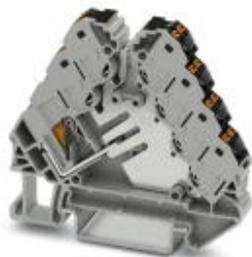
Potenzialverteiler, mit Einspeisemöglichkeit bis zu 6 mm<sup>2</sup>, Nennspannung: 250 V, Nennstrom: 17,5 A, Querschnitt: 0,14 mm<sup>2</sup> - 2,5 mm<sup>2</sup>, AWG: 14 - 26, Anschlussart: Push-in-Anschluss, Polzahl: 2, Anzahl Anschlüsse: 13, Breite: 8,3 mm, Länge: 64 mm, Farbe: grau, Farbe Anschlusselemente: schwarz, Montage: NS 35/7,5, NS 35/15
