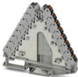
Potenzialverteiler, Nennspannung: 250 V, Nennstrom: 17,5 A, Querschnitt: 0,14 mm<sup>2</sup> - 2,5 mm<sup>2</sup>, AWG: 14 - 26, Anschlussart: Push-in-Anschluss, Polzahl: 2, Anzahl Anschlüsse: 32, Breite: 8,3 mm, Länge: 100 mm, Farbe: grau, Farbe Anschlusselemente: schwarz, Montage: NS 35/7,5, NS 35/15
