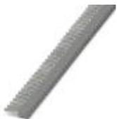
Aderendhülse, Maße nach DIN 46228-4, mit Kunststoffkragen im Farbcode angelehnt an die NF C 63-023:1994-02, zur Verarbeitung mit der CRIMPFOX 4 in 1, Hülsenlänge: 8 mm, Länge: 14 mm, Farbe: grau, Anzahl der Streifen: 10, Anzahl der Hülsen pro Streifen: 40
