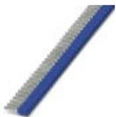
Aderendhülse, Maße nach DIN 46228-4, mit Kunststoffkragen im Farbcode angelehnt an die NF C 63-023:1994-02, zur Verarbeitung mit der CRIMPFOX 4 in 1, Hülsenlänge: 8 mm, Länge: 14 mm, Farbe: blau, Anzahl der Streifen: 10, Anzahl der Hülsen pro Streifen: 50
