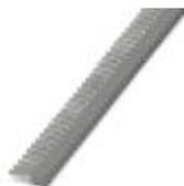
Band-Aderendhülsen, 0,75 mm<sup>2</sup>, Hülsenlänge 8 mm, mit Kunststoffkragen, nach DIN 46228-4, grau, zur Verarbeitung mit der CRIMPFOX 4 IN 1, 10 Streifen mit je 50 Hülsen pro Streifen.
