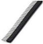
Band-Aderendhülsen, 1,5 mm<sup>2</sup>, Hülsenlänge 8 mm, mit Kunststoffkragen, nach DIN 46228-4, schwarz, zur Verarbeitung mit der CRIMPFOX 4 IN 1, 10 Streifen mit je 50 Hülsen pro Streifen.
