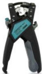
Werkzeug zur Verarbeitung von Aderendhülsen nach DIN 46228-4 0,5 mm<sup>2</sup> bis 2,5 mm<sup>2</sup> ausgestattet mit Zwangssperre, Magazin, Schneid-, Abisolier-, Verdrill- und Crimpeinheit.
