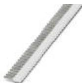
Band-Aderendhülsen, 0,5 mm<sup>2</sup>, Hülsenlänge 8 mm, mit Kunststoffkragen, nach DIN 46228-4, weiß, zur Verarbeitung mit der CRIMPFOX 4 IN 1, 10 Streifen mit je 50 Hülsen pro Streifen.
