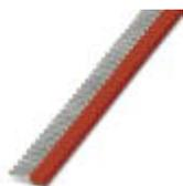
Band-Aderendhülsen, 1,0 mm<sup>2</sup>, Hülsenlänge 8 mm, mit Kunststoffkragen, nach DIN 46228-4, rot, zur Verarbeitung mit der CRIMPFOX 4 IN 1, 10 Streifen mit je 50 Hülsen pro Streifen.
