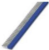
Band-Aderendhülsen, 2,5 mm<sup>2</sup>, Hülsenlänge 8 mm, mit Kunststoffkragen, nach DIN 46228-4, blau, zur Verarbeitung mit der CRIMPFOX 4 IN 1, 10 Streifen mit je 40 Hülsen pro Streifen.
