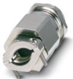
Kabelverschraubung, Material Verschraubung: Messing, vernickelt, Anwendung: Standard, Kabelaußendurchmesser 9 mm ... 17 mm, Schirmung: nein, Anschlussgewinde: M25 x 1,5, Farbe: silberfarben, mit externer Zugentlastung, mit O-Ring
