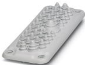
Kabeldurchführungsplatte, Anzahl der Leitungen: 37, Länge: 222 mm, Breite: 92 mm, Höhe: 29,5 mm, Leitungsaußendurchmesser: 4x 6 mm ... 10 mm, Farbe: grau
