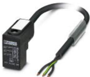
Sensor-/Aktor-Kabel, 3-polig, PVC, schwarz RAL 9005, freies Leitungsende, auf Ventilstecker CI (9,4 mm), mit 1 LED, beschaltet mit Varistor, Kabellänge: 5 m
