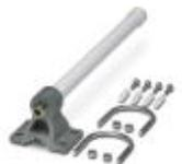
Rundstrahlantenne, 868 MHz, Gewinn: 4 dBi, Polarisation: linear, Öffnungswinkel: h/v 360°/30°, Schutzart: IP67, seewasserbeständig, Anschluss: N (female), inkl. Montagewinkel und Mastschellen, ATEX- und IECEx-Zulassung
