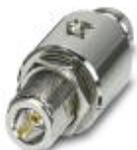
Antennenbarriere für die Schaltschrankdurchführung, Zündschutzart: Ex i, Schutzart: IP65, Installation Barriere: Zone 2, Installation Antenne: Zone 0, 1 oder 2, Frequenzbereich: 0,3 GHz ... 6 GHz, Anschluss: 2 x N (female), ATEX- und IECEx-Zulassung
