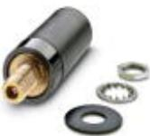
Rundstrahlantenne, 868 MHz / 900 MHz, Gewinn: 2 dBi, Polarisation: linear, Öffnungswinkel: h/v 360°/50°, Schutzart: IP66, Anschluss: N (female), für Schaltschrankmontage (optional Wandmontage)
