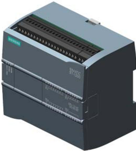
SIPLUS S7-1200 CPU 1214C DC/DC/DC -40...+60°C mit Conformal Coating based on 6ES7214-1AG40-0XB0 signal board verwendbar. . Kompakt-CPU, DC/DC/DC, onboard I/O: "14 DI 24VDC; 10 DO 24VDC;" 2 AI 0-10VDC, Stromversorgung: DC 20,4-28,8V DC, Programm-/Datenspeicher 100 KB
