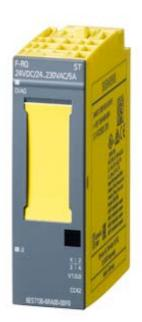
SIMATIC DP, Elektronikmodul f. ET200SP, F-RQ 1x 24VDC/24..230VAC/5A ST, 20mm Baubr., 1 Relais-Ausgang (2S) SUMMENAUSGANGSSTROM 5A, Lastspannung DC 24V und AC 24.. 230V, einsetzbar bis PL E (ISO 13849-1: 2008)/ SIL 3 (IEC 61508: 2010) wenn die Ansteuerung durch F-DQ (z.B. 6ES7136-6DB00-0CA0) erfolgt
