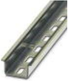
Tragschiene gelocht, Standardprofil, Breite: 35 mm, Höhe: 15 mm, ähnlich EN 60715: 2001, Material: Stahl, verzinkt, dickschichtpassiviert, Länge: 2000 mm, Farbe: silberfarben
