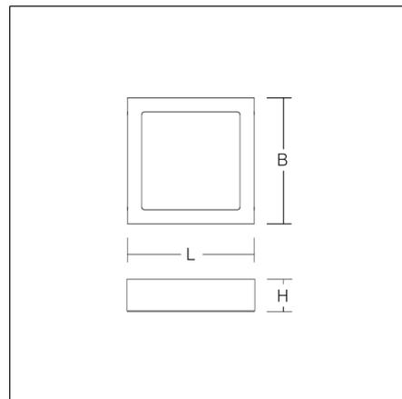
Anbaugehäuse Stahlblech pulverbeschichtet. Downlight werkzeuglos verriegelbar. Für Einbau-Downlight Toledo Flat Square 300x300.
