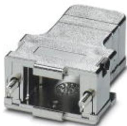
D-SUB-Tüllegehäuse, Schutzart: IP20, Material: ABS, metallisiert, Kabelabgang: gewinkelt, Gehäusegröße: 1, Farbe: metallisch blank
