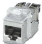
RJ45-Buchseneinsatz, Bauform: RJ45, Schutzart: IP20, Polzahl: 8, 10 GBit/s, CAT6<sub>A</sub>, Material: Zink-Druckguss, Anschlussart: IDC-Anschluss, Anschlussquerschnitt: AWG 26-22, Verwendung nur mit IP20-Anbaurahmen oder direkte Integration in die Gehäusewand
