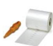
Marker für Klemmen, Rolle, grün, unbeschriftet, beschriftbar mit: THERMOMARK ROLL, THERMOMARK ROLL X1, THERMOMARK ROLLMASTER 300/600, THERMOMARK X1.2, THERMOMARK S1.1, perforiert, Montageart: verrasten in Universalschildchennut, verrasten in flacher Schildchennut, für Klemmenbreite: 5,2 mm, Schriftfeldgröße: 6,4 x 5,15 mm
