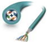
Netzwerkkabel, Ethernet CAT5 (1 GBit/s), 8-polig, PUR halogenfrei, wasserblau RAL 5021, geschirmt, freies Leitungsende, auf freies Leitungsende, Kabellänge: Freie Eingabe (0,5 ... 400 m)
