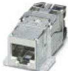
RJ45-Buchseneinsatz, Bauform: RJ45, Schutzart: IP20, Polzahl: 8, 10 GBit/s, CAT6<sub>A</sub>, Material: Zink-Druckguss, Anschlussart: IDC-Anschluss, Anschlussquerschnitt: AWG 26-22
