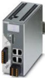
Managed Ethernet-Extender, Punkt-zu-Punkt-, Linien- und Ringstrukturen, Datenraten bis 30 MBit/s, Distanzen bis 20 km auf betriebseigenen Kupferleitungen, austauschbarer Überspannungsschutz, 2 SHDSL-Ports, 4-Port Switch, Diagnose via Display und Ethernet
