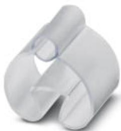
Ader-Bezeichnungsträger, transparent, unbeschriftet, Montageart: aufschieben, Kabeldurchmesserbereich: 10-14 mm, Schriftfeldgröße: 12 x 5 mm
