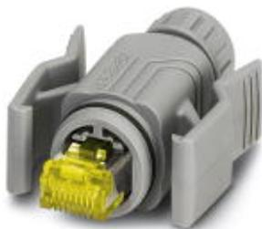
RJ45-Steckverbinder, Schutzart: IP67, 10 GBit/s, CAT6<sub>A</sub>, Material: PA, Anschlussart: Crimpanschluss, Anschlussquerschnitt: AWG 24-27, Kabelabgang: gerade, Farbe: grau
