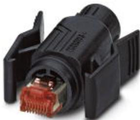
RJ45-Steckverbinder, Schutzart: IP67, Polzahl: 8, 1 GBit/s, CAT6, Material: PA, Anschlussart: Crimpanschluss, Anschlussquerschnitt: AWG 24-27, Kabelabgang: gerade, Farbe: schwarz
