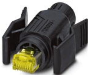
RJ45-Steckverbinder, Schutzart: IP67, Polzahl: 8, 10 GBit/s, CAT6<sub>A</sub>, Material: PA, Anschlussart: Crimpanschluss, Anschlussquerschnitt: AWG 24-27, Kabelabgang: gerade, Farbe: schwarz
