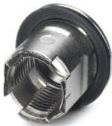
M12-Gewindehülse mit toleranzausgleichender Funktion, für gerade, THR-fähige M12-Buchsenkontakteinsätze. Geeignet für Frontplattenwandstärken von 1,0 mm ... 1,8 mm.
