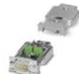
D-SUB-Stecker, 9-polig, Stift, axiale Ausführung mit zwei Kabelzuführungen, Bussystem: PROFIBUS DP bis 12 MBit/s, Abschlusswiderstand über Schiebeschalter zuschaltbar, Pinbelegung: 3, 5, 6, 8; Schraubanschlussklemmen
