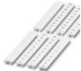
Zackband, Streifen, weiß, beschriftet, beschriftbar mit: CMS-P1-PLOTTER, längs bedruckt: fortlaufende Zahlen 1-10, 11-20 usw. bis 491-500, Montageart: verrasten in hoher Schildchennut, für Klemmenbreite: 8,2 mm, Schriftfeldgröße: 10,5 x 8,15 mm
