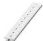
Zackband, Streifen, weiß, beschriftet, beschriftbar mit: CMS-P1-PLOTTER, quer bedruckt: fortlaufende Zahlen 1-10, 11-20 usw. bis 91-100, Montageart: verrasten in hoher Schildchennut, für Klemmenbreite: 8,2 mm, Schriftfeldgröße: 10,5 x 8,15 mm
