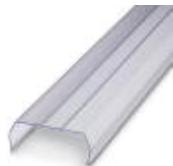
Abdeckprofil, zum Abdecken von Klemmenleisten, wird auf Abdeckprofilträger APT-ME oder Endhalter APH-ME gerastert. An den Enden und in Abständen von ca. 40 cm ist ein Abdeckprofilträger zu setzen. Lieferlänge: 1 m
