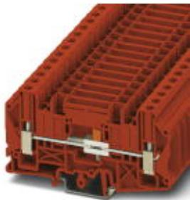
Trennklemme, Anschlussart: Schraubanschluss, Querschnitt: 0,2 mm<sup>2</sup> - 10 mm<sup>2</sup>, AWG: 24 - 8, Breite: 8,2 mm, Montageart: NS 35/7,5, NS 35/15, NS 32, Farbe: rot
