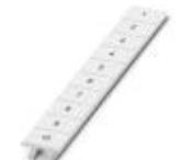
Zackband, Streifen, weiß, beschriftet, beschriftbar mit: CMS-P1-PLOTTER, quer bedruckt: fortlaufende Zahlen 1-10, 11-20 usw. bis 91-100, Montageart: verrasten in hoher Schildchennut, für Klemmenbreite: 8,2 mm, Schriftfeldgröße: 10,5 x 8,15 mm
