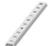
Zackband flach, Streifen, weiß, beschriftet, längs bedruckt: fortlaufende Zahlen 1-10, 11-20 usw. bis 91-100, Montageart: verrasten in flacher Schildchennut, für Klemmenbreite: 6,2 mm, Schriftfeldgröße: 5,15 x 6,15 mm
