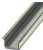
Tragschiene ungelocht, Standardprofil, Breite: 35 mm, Höhe: 15 mm, ähnlich EN 60715: 2001, Material: Stahl, verzinkt, dickschichtpassiviert, Länge: 2000 mm, Farbe: silberfarben
