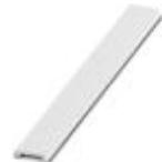
Zackband flach, Streifen, weiß, unbeschriftet, beschriftbar mit: CMS-P1-PLOTTER, PLOTMARK, Montageart: verrasten in flacher Schildchennut, für Klemmenbreite: 5 mm, Schriftfeldgröße: 5,1 x 5,2 mm
