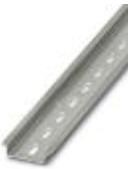
Tragschiene gelocht, Standardprofil, Breite: 35 mm, Höhe: 7,5 mm, nach EN 60715: 2001, Material: Stahl, verzinkt, dickschichtpassiviert, Länge: 2000 mm, Farbe: silber
