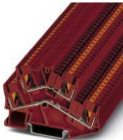
Doppelstockklemme, Anschlussart: Push-in-Anschluss, Querschnitt: 0,14 mm<sup>2</sup> - 4 mm<sup>2</sup>, AWG: 26 - 12, Breite: 5,2 mm, Farbe: rot, Montageart: NS 35/7,5, NS 35/15
