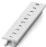
Zackband, Streifen, weiß, beschriftet, längs bedruckt: fortlaufende Zahlen 1-10, 11-20 usw. bis 491-500, Montageart: verrasten in hoher Schildchennut, für Klemmenbreite: 5,2 mm, Schriftfeldgröße: 5,15 x 10,5 mm
