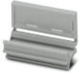
Gruppenbezeichnungsschild, einrastbar in Klemmenmitte für Schraub-, Zugfeder- und Schnellanschlussklemmen, beschriftbar mit Einstechstreifen ESL 26 x 6 mm oder EST 25 x 6 mm, im Fußteil mit Zackband, Länge: 29 mm
