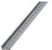
Tragschiene gelocht, Standardprofil, Breite: 35 mm, Höhe: 7,5 mm, nach EN 60715: 2001, Material: Stahl, verzinkt, weiß-passiviert, Länge: 2000 mm, Farbe: weiß
