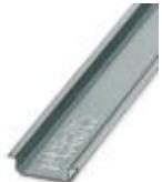
Tragschiene ungelocht, Standardprofil, Breite: 35 mm, Höhe: 7,5 mm, nach EN 60715: 2001, Material: Stahl, verzinkt, weiß-passiviert, Länge: 2000 mm, Farbe: weiß
