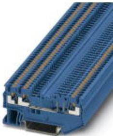
Trennklemme, Nennspannung: 400 V, Nennstrom: 10 A, Anschlussart: Push-in-Anschluss, Querschnitt: 0,14 mm<sup>2</sup> - 1,5 mm<sup>2</sup>, AWG: 26 - 14, Länge: 67,8 mm, Breite: 3,5 mm, Farbe: blau, Montage: NS 35/7,5, NS 35/15, Nennspannung: 400 V
