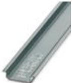
Tragschiene ungelocht, Standardprofil, Breite: 35 mm, Höhe: 7,5 mm, nach EN 60715: 2001, Material: Stahl, verzinkt, weiß-passiviert, Länge: 2000 mm, Farbe: weiß
