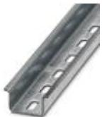
Tragschiene gelocht, Standardprofil, Breite: 35 mm, Höhe: 15 mm, ähnlich EN 60715: 2001, Material: Stahl, verzinkt, Länge: 2000 mm, Farbe: silberfarben
