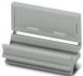
Gruppenbezeichnungsschild, einrastbar in Klemmenmitte für Schraub-, Zugfeder- und Schnellanschlussklemmen, beschriftbar mit Einstekstreifen ESL 26 x 6 mm oder EST 25 x 6 mm, im Fußteil mit Zackband, Länge: 29 mm
