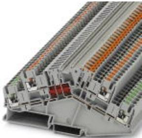
Trennklemme, Doppelstock mit schräger Kontur, einem Trennmesser und einer Trennstelle, Nennspannung: 400 V, Nennstrom: 16 A, Anschlussart: Push-in-Anschluss, Querschnitt: 0,14 mm<sup>2</sup> - 4 mm<sup>2</sup>, AWG: 26 - 12, Länge: 127,5 mm, Breite: 5,2 mm, Farbe: grau, Montage: NS 35/7,5, NS 35/15, Nennspannung: 400 V
