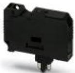
Sicherungsstecker, Art der Sicherung: Glas / Keramik / ..., Anschlussart: Steckanschluss, Nennstrom: 10 A, Breite: 8,2 mm, Sicherungstyp: G / 6,3 x 32, Montageart: Steckmontage, Farbe: schwarz
