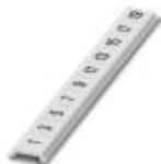
Zackband flach, Streifen, weiß, beschriftet, längs bedruckt: ungerade Zahlen 1-19, 21-39 usw. bis 81-99, Montageart: verrasten in flacher Schildchennut, für Klemmenbreite: 5 mm, Schriftfeldgröße: 5,15 x 5,15 mm
