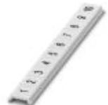
Zackband flach, Streifen, weiß, beschriftet, längs bedruckt: fortlaufende Zahlen 1-10, 11-20 usw. bis 491-500, Montageart: verrasten in flacher Schildchennut, für Klemmenbreite: 5 mm, Schriftfeldgröße: 5,15 x 5,15 mm
