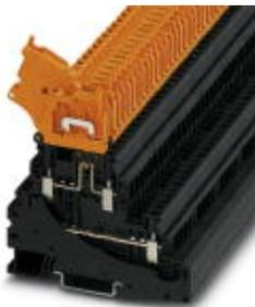
Hebeltrennklemme, Nennspannung: 500 V, Nennstrom: 28 A, Anschlussart: Schraubanschluss, Querschnitt: 0,14 mm<sup>2</sup> - 4 mm<sup>2</sup>, AWG: 26 - 10, Länge: 92,7 mm, Breite: 6,2 mm, Farbe: schwarz, Montage: NS 35/7,5, NS 35/15, Nennspannung: 500 V
