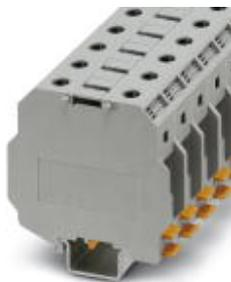
Hochstromklemme, Nennspannung: 1500 V, Nennstrom: 150 A, Anschlussart: Schraubanschluss, Anzahl der Anschlüsse: 2, Querschnitt: 16 mm<sup>2</sup> - 70 mm<sup>2</sup>, AWG: 6 - 2/0, Breite: 20 mm, Höhe: 76 mm, Farbe: grau, Montageart: NS 35/7,5, NS 35/15, NS 32, NS 35/15-2,3
