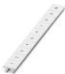
Zackband, Streifen, weiß, beschriftet, beschriftbar mit: CMS-P1-PLOTTER, längs bedruckt: fortlaufende Zahlen 1-10, 11-20 usw. bis 991-1000, Montageart: verrasten in hoher Schildchennut, für Klemmenbreite: 10,2 mm, Schriftfeldgröße: 10,15 x 10,5 mm
