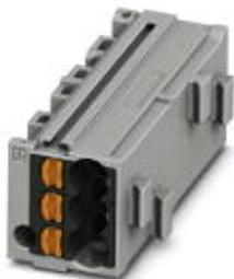
Rangierwabe, Nennspannung: 500 V, Nennstrom: 17,5 A, Querschnitt: 0,14 mm<sup>2</sup> - 2,5 mm<sup>2</sup>, AWG: 14 - 26, Anschlussart: Push-in-Anschluss, Polzahl: 1, Anzahl Anschlüsse: 6, Breite: 11 mm, Länge: 12,2 mm, Farbe: grau, Farbe Anschlusselemente: schwarz, Montage: aufrasten auf Tragschienenadapter, aufrasten auf Deckelflansch
