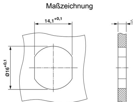
Gehäuseausschnitt mit Verdrehschutz. Gehäuseverschraubung vormontiert auf Isolierkörper mit anschließender Montage in der Frontplatte.
