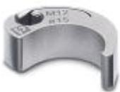
Steckaufsatz zur Montage von Sensor-/Aktor-Kabeln mit M12-Steckverbinder und von konfektionierbaren M12-Steckverbindern, Rändeldurchmesser: 16 mm, für 4 mm Sechskantantrieb
