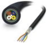
Netzwerkkabel, PROFINET CAT5 (100 MBit/s), 4-polig, PE-X halogenfrei, schwarz RAL 9005, geschirmt, freies Leitungsende, auf freies Leitungsende, Kabellänge: Freie Eingabe (0,5 ... 400 m), für Bahnanwendungen
