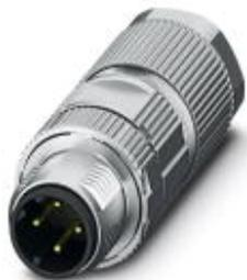
Steckverbinder, PROFINET CAT5 (100 MBit/s), 4-polig, geschirmt, Stecker gerade M12, D-kodiert, Crimpanschluss, Rändelmaterial: Zinkdruckguss, vernickelt, Kabelaußendurchmesser 4,5 mm ... 7,5 mm, ohne Crimpkontakte
