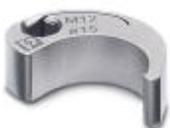
Steckaufsatz zur Montage von Sensor-/Aktor-Kabeln mit M12-Steckverbinder und von konfektionierbaren M12-Steckverbindern, Rändeldurchmesser: 16 mm, für 4 mm Sechskantantrieb
