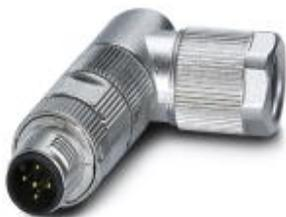
Steckverbinder, Universal, 5-polig, geschirmt, Stecker gewinkelt M12, A-kodiert, Crimpanschluss, Rändelmaterial: Zinkdruckguss, vernickelt, Kabelaußendurchmesser 4,5 mm ... 7,5 mm, ohne Crimpkontakte
