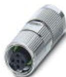
Steckverbinder, Universal, 5-polig, geschirmt, Buchse gerade M12, A-kodiert, Crimpanschluss, Rändelmaterial: Zinkdruckguss, vernickelt, Kabelaußendurchmesser 4,5 mm ... 7,5 mm, ohne Crimpkontakte
