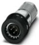
Steckverbinder, PROFINET CAT5 (100 MBit/s), 4-polig, geschirmt, Stecker gerade M12 Push-Pull, D-kodiert, Crimpanschluss, Rändelmaterial: PA 66, Kabelaußendurchmesser 4,5 mm ... 7,5 mm, ohne Crimpkontakte
