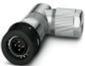
Steckverbinder, Universal, 5-polig, geschirmt, Stecker gewinkelt M12 Push-Pull, A-kodiert, Crimpanschluss, Rändelmaterial: PA 66, Kabelaußendurchmesser 4,5 mm ... 7,5 mm, ohne Crimpkontakte
