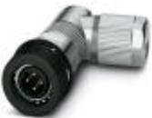
Steckverbinder, PROFINET CAT5 (100 MBit/s), 4-polig, geschirmt, Stecker gewinkelt M12 Push-Pull, D-kodiert, Crimpanschluss, Rändelmaterial: PA 66, Kabelaußendurchmesser 4,5 mm ... 7,5 mm, ohne Crimpkontakte
