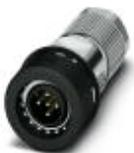
Steckverbinder, Universal, 5-polig, geschirmt, Stecker gerade M12 Push-Pull, A-kodiert, Crimpanschluss, Rändelmaterial: PA 66, Kabelaußendurchmesser 4,5 mm ... 7,5 mm, ohne Crimpkontakte
