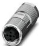
Steckverbinder, PROFINET CAT5 (100 MBit/s), 4-polig, geschirmt, Buchse gerade M12, D-kodiert, Crimpanschluss, Rändelmaterial: Zinkdruckguss, vernickelt, Kabelaußendurchmesser 4,5 mm ... 7,5 mm, ohne Crimpkontakte
