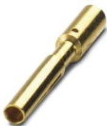
Crimpkontakt, Kontaktdurchmesser: 1 mm, gedreht, Buchse, Material Kontakt: CuZn, Kontaktfläche: Ni/Au, Anschlussquerschnitt: 0,34 mm<sup>2</sup> ... 1 mm<sup>2</sup>
