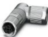
Steckverbinder, PROFINET CAT5 (100 MBit/s), 4-polig, geschirmt, Buchse gewinkelt M12, D-kodiert, Crimpanschluss, Rändelmaterial: Zinkdruckguss, vernickelt, Kabelaußendurchmesser 4,5 mm ... 7,5 mm, ohne Crimpkontakte
