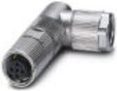
Steckverbinder, Universal, 5-polig, geschirmt, Buchse gewinkelt M12, A-kodiert, Crimpanschluss, Rändelmaterial: Zinkdruckguss, vernickelt, Kabelaußendurchmesser 4,5 mm ... 7,5 mm, ohne Crimpkontakte
