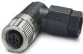
Steckverbinder, 5-polig, Buchse gewinkelt M12, A-kodiert, Push-in-Anschluss, Rändelmaterial: Zinkdruckguss, vernickelt, Kabelaußendurchmesser 4 mm ... 8 mm
